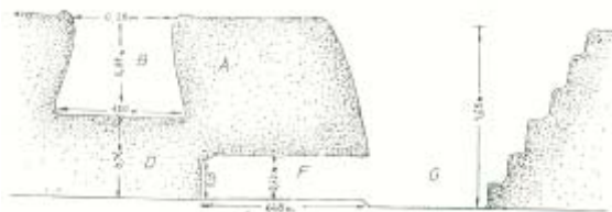
Fig. 13. Reconstituirea cuptorului nr. 1 de la trușești, punctul La Cuha (după Fl.B.Florescu și A. Nițu). Secțiune în lungul gurii de foc
